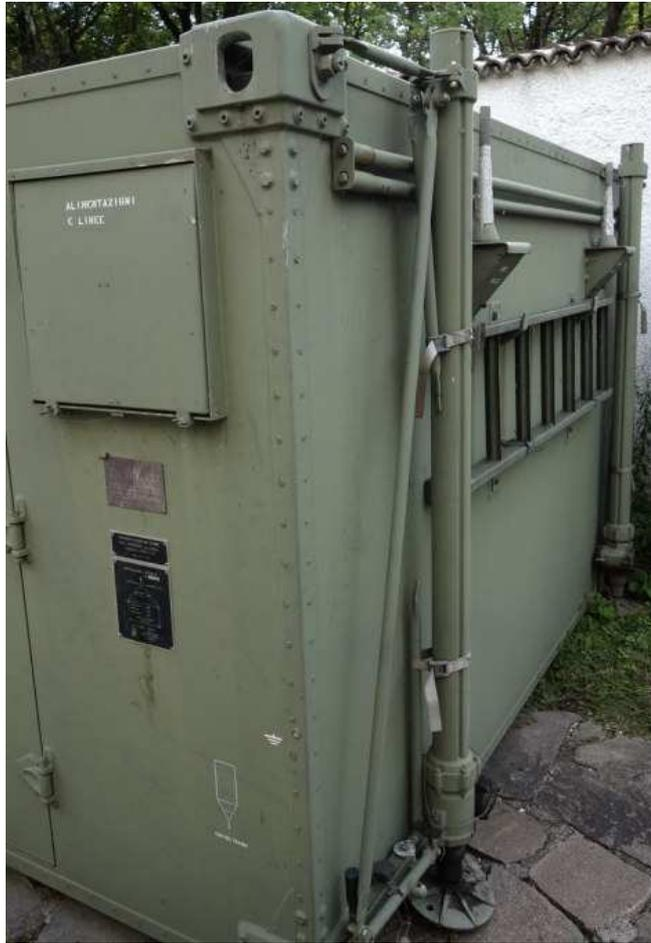
**Vista laterale con in evidenza:** due dei quattro martinetti di movimentazione le basi laterali per le antenne riceventi (quella di trasmissione è sulla parete frontale) in primo piano il pannello con le connessioni verso il mondo esterno
