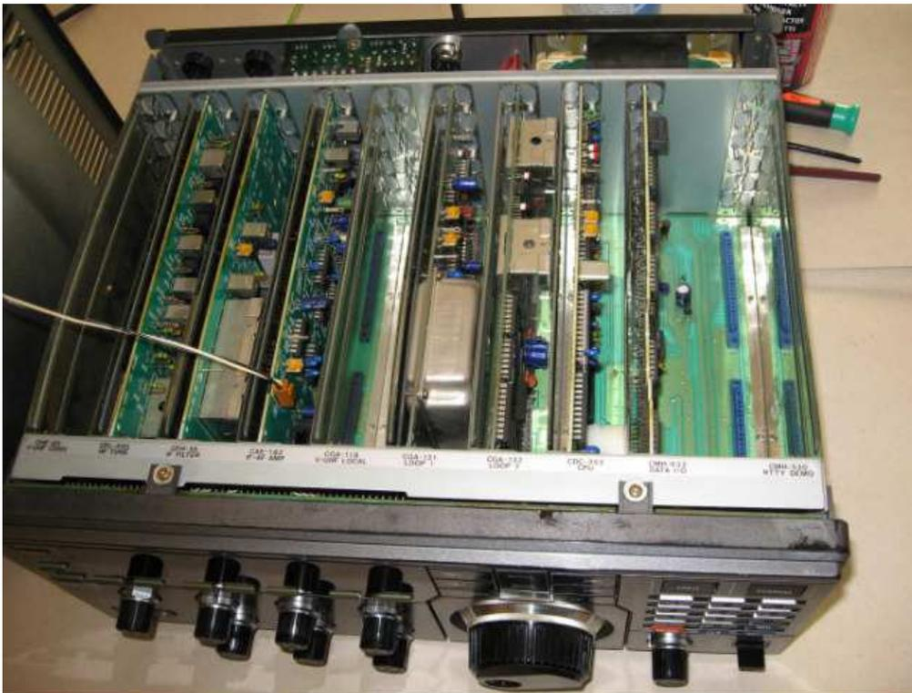
Altro passo per la pulizia è stata la rimozione di tutte le manopole (montate a pressione) esclusa quella di sintonia che si sblocca con una chiavetta a brugola passo millimetrico da mm 1,5.
