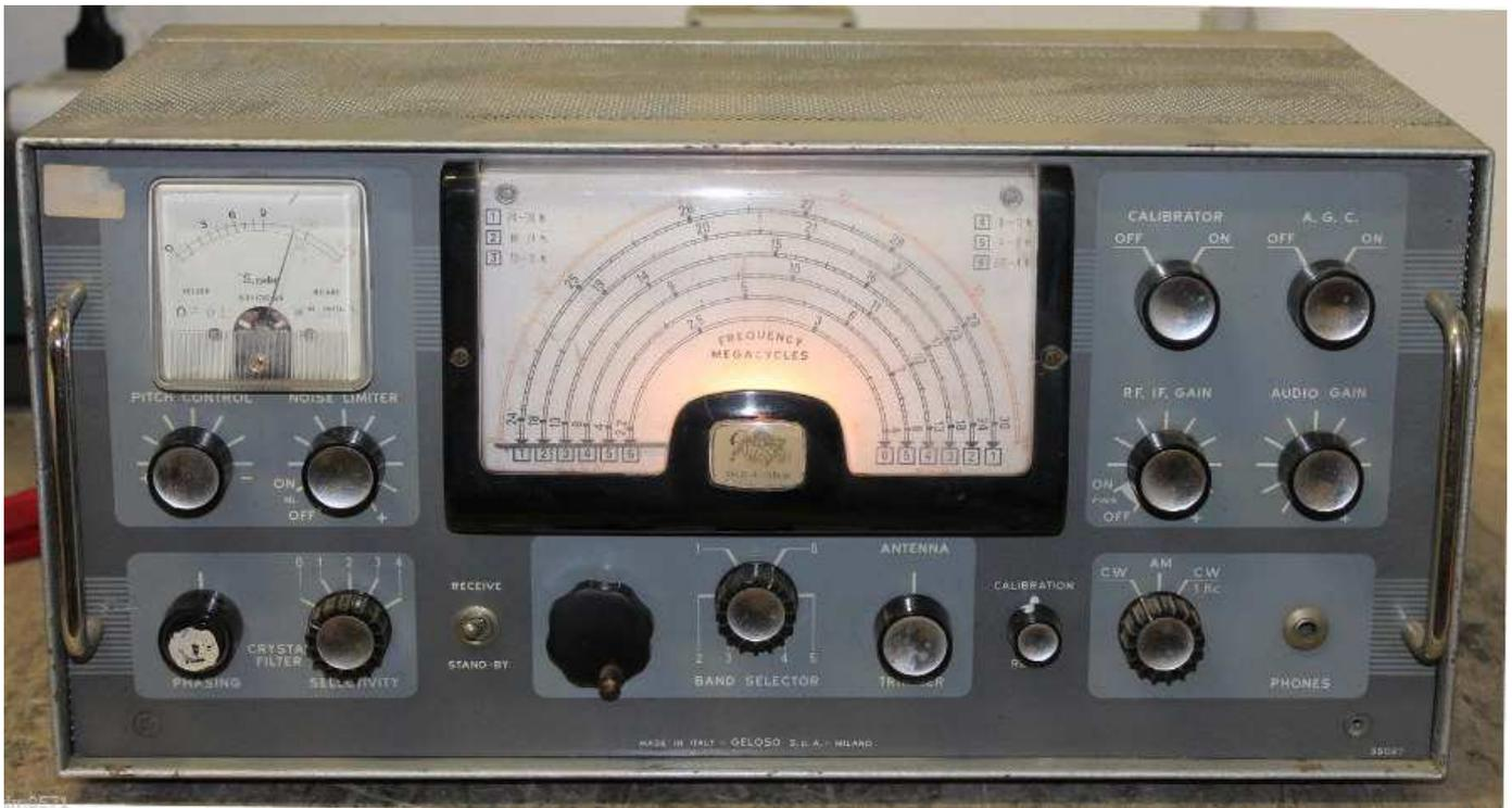
**G 219** Ricevitore rarissimo derivato dal G4/214 dotato di un apposito gruppo RF 2624 da 2,2 MHz a 30 MHz usato sui pescherecci come ricevitore di bordo
