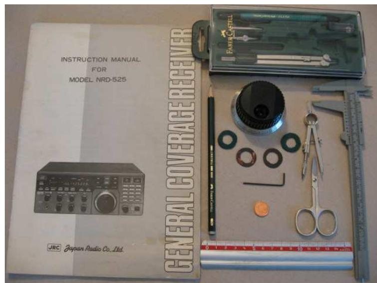
Completata la pulizia delle manopole e dopo aver smontato la manopola del Tuning , troppo morbida nella sua rotazione ,ho pensato di creare una sorta di frizione interponendo tra il frontale e la manopola n°4 dischetti di cartone con incollato un feltro per formare adeguato spessore e creare una leggerissima frizione nella rotazione del comando di sintonia.
