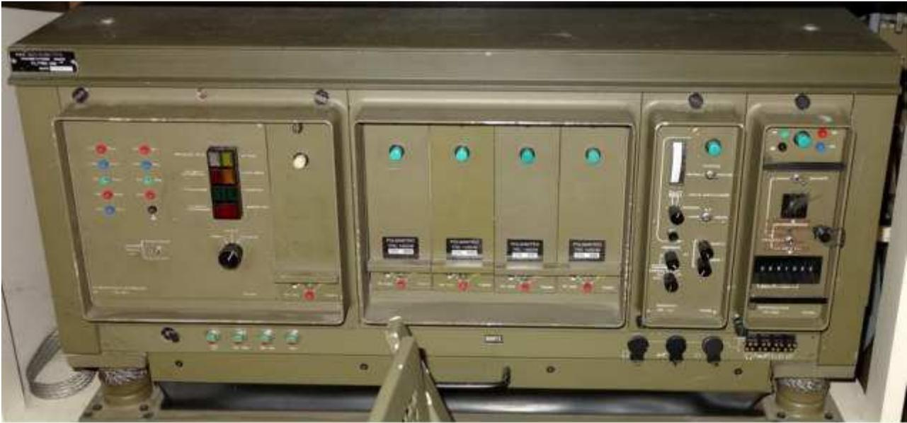
**Trasmittitore. Al centro i 4 moduli di potenza sostituibili a caldo**
