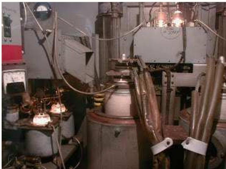
All'interno dello stadio pilota e finale RF di un trasmettitore .
