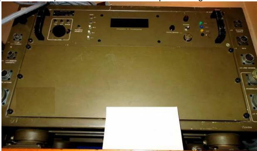
**Unità centrale di telecomando (sviluppata in Telettra)**
