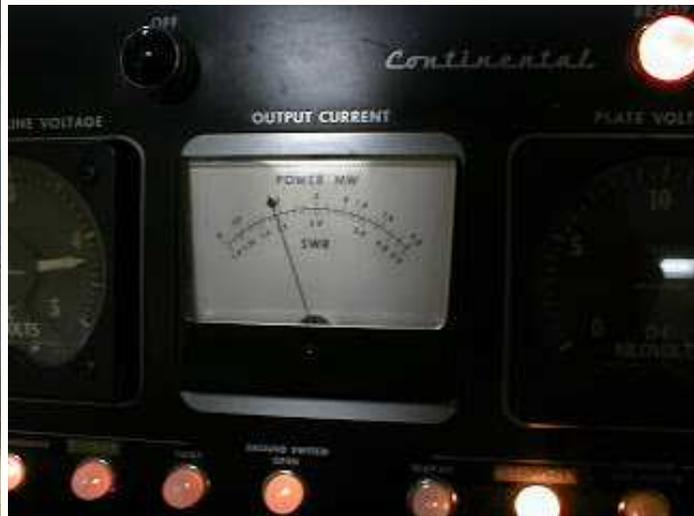
Pilota dello stadio modulatore Audio Frequenza di uno dei trasmettitori .Lo strumento che misura la potenza di uscita . Il fondo scala e' 2MW ( 2000 KW ) .In questo momento il trasmettitore sta operando a potenza molto ridotta : circa 180 KW.
